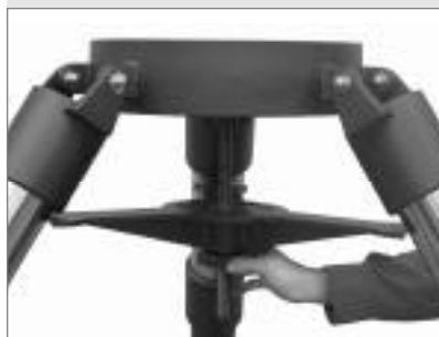
Fig. 46 : Serrez l'écarteur avec la molette.
