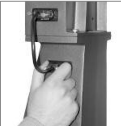
Fig. 54 : Branchez les fiches DB-9 pour alimenter le moteur d'entraînement en déclinaison depuis la fourche.
