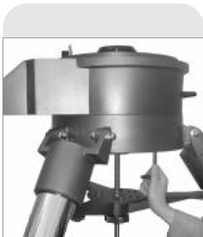
Fig. 48 : fixez l'embase au trépied.
