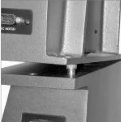
Fig. 52 : Positionnez les orifices sur les boulons. Quand ils sont en place, faites glisser le tube optique en arrière jusqu'à ce qu'ils rentrent dans les fentes.
