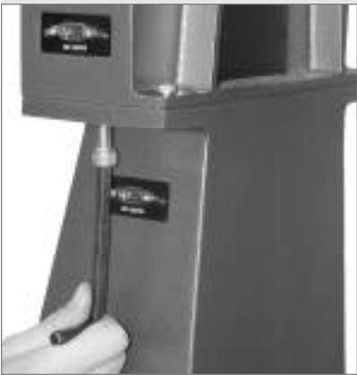
Fig. 53 : Serrez les bras de la fourche à l'aide de la clé à six pans
