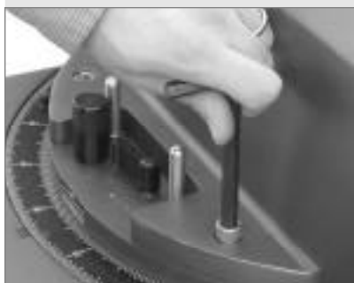
Fig. 49 : Boulonnez la fourche à l'embase.
