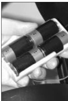
Fig. 5 : quatre piles installées à l'intérieur d'un des portes piles. Notez leur position dans le compartiment.
